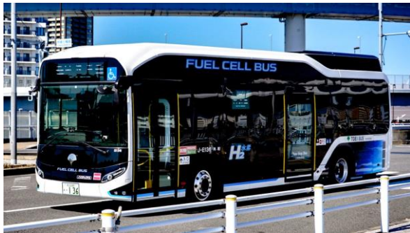
「水素」と空気中の「酸素」を反応させて電気を起こす燃料電池搭載バス
