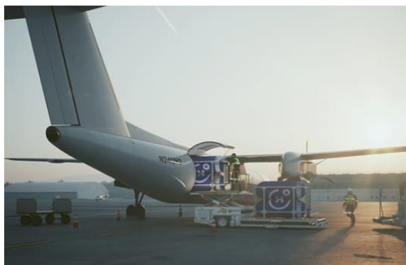
水素の燃料タンクを搭載した航空機（ユニバーサル・ハイドロジェン社のHPより）
